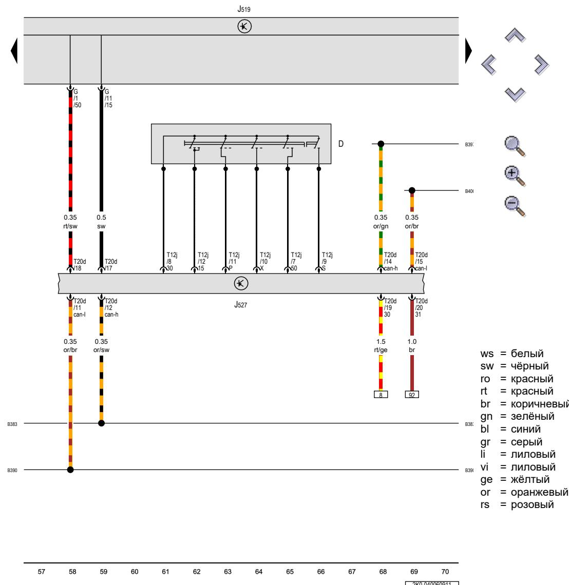
**Выключатель зажигания и стартера, Блок управления бортовой сети, Блок управления рулевой колонки**
